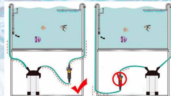
Обогреватель врезают в ВЫХОДНОЙ шланг внешнего фильтра. Врезать его во входной шланг нельзя!
